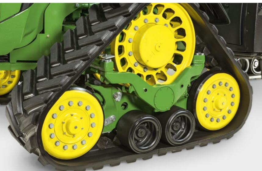
La superficie di contatto con il terreno di 4,57 m<sup>2</sup> è il punto di riferimento in questa classe di potenza. Anche con una zavorra completa, la pressione statica al suolo sul lato posteriore è di soli 36 kPa. La mancanza di tenuta su strada a finecampo è quasi inesistente, sebbene il raggio di sterzo sia persino più piccolo di quello di un trattore gommato Serie 8.
