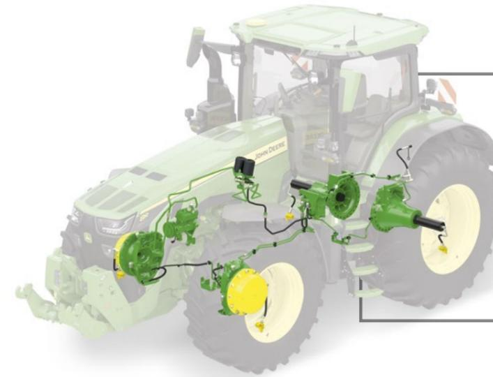
Il diametro interno dei robusti tubi dell'aria del sistema di gonfiaggio centralizzato degli pneumatici John Deere è più grande del 33% rispetto ad altri sistemi integrati della concorrenza, per garantire tempi di gonfiaggio e sgonfiaggio più rapidi. La tecnologia intelligente delle valvole delle ruote ci permette di sfruttare un sistema a tubazione unica in cui i tubi dell'aria non rimangono sotto pressione permanente.
