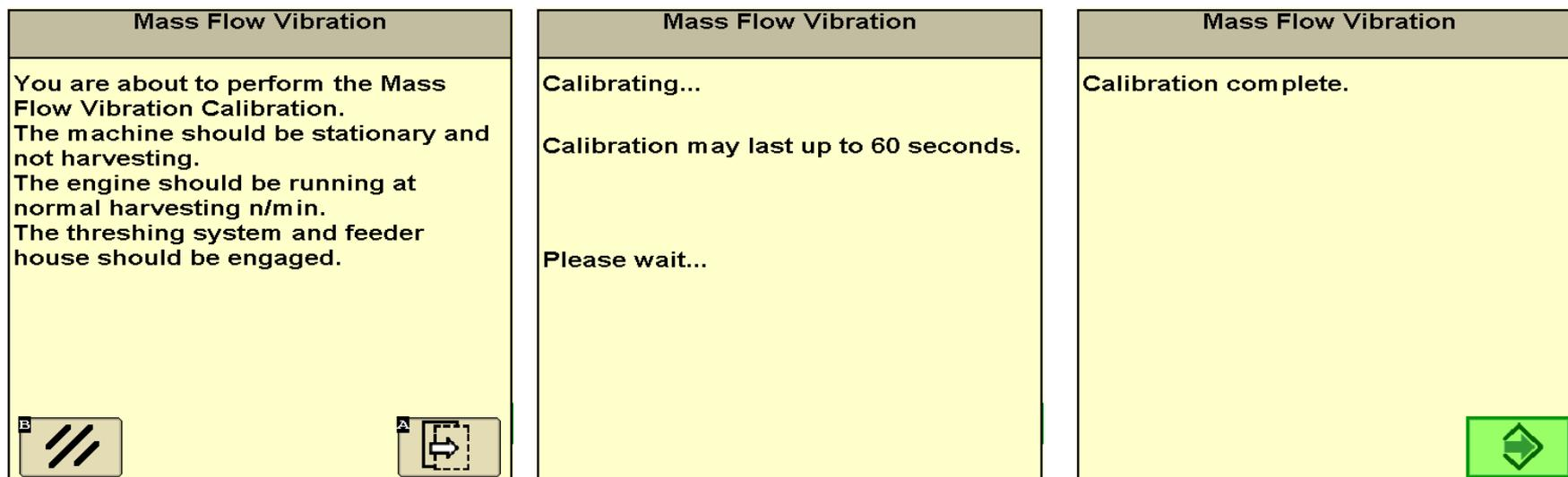
4. Seguire le istruzioni nella calibrazione. Inserire la testata e il separatore, con la testata in posizione di raccolta portare il regime del motore al regime di massimo a vuoto, accertarsi che la testata non poggi sul terreno e la tramoggia sia vuota.
