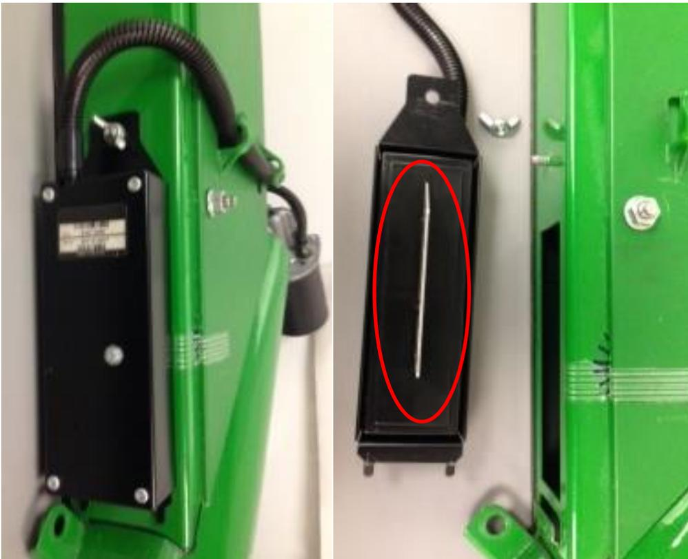
Pulire il sensore ad ogni stagione o secondo necessità, in particolare se le letture di umidità sono irregolari.
