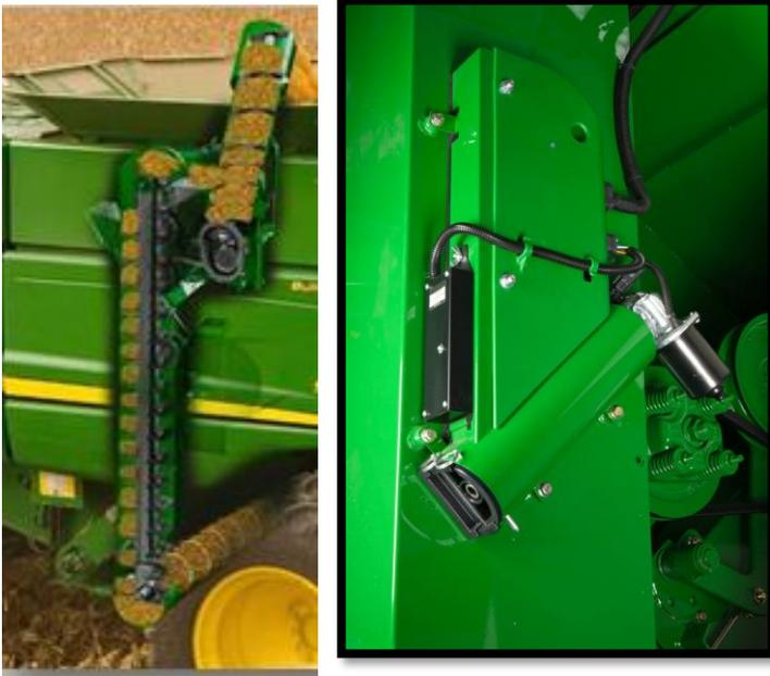
L'alloggiamento del sensore di umidità è montato sul lato dell'elevatore della granella pulita. La granella cade nel sensore dalle palette sul "lato alto" dell'elevatore. La granella riempie la camera del sensore oltre il sensore di umidità, viene registrato un valore di umidità e la granella viene quindi spinta dalla coclea nel lato di ritorno dell'elevatore.
