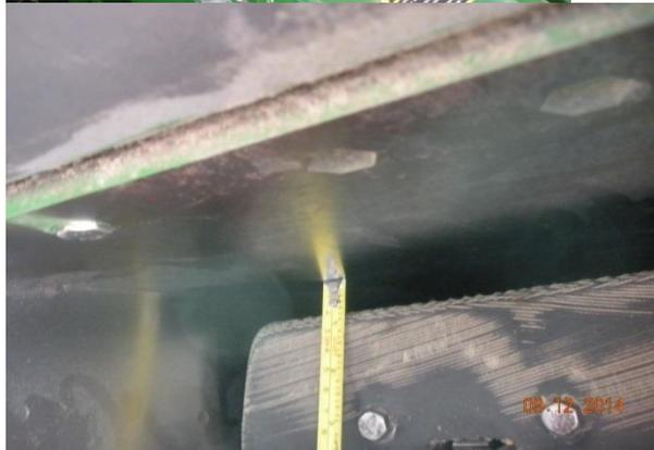
1. Ruotare la catena dell'elevatore della granella pulita fino a quando una paletta della catena è in posizione verticale sulla parte superiore dell'alloggiamento dell'elevatore nella tramoggia.
