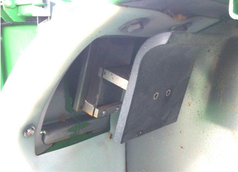
1. Ispezionare visivamente e pulire l'area circostante il sensore resa di flusso e la piastra di impatto.
