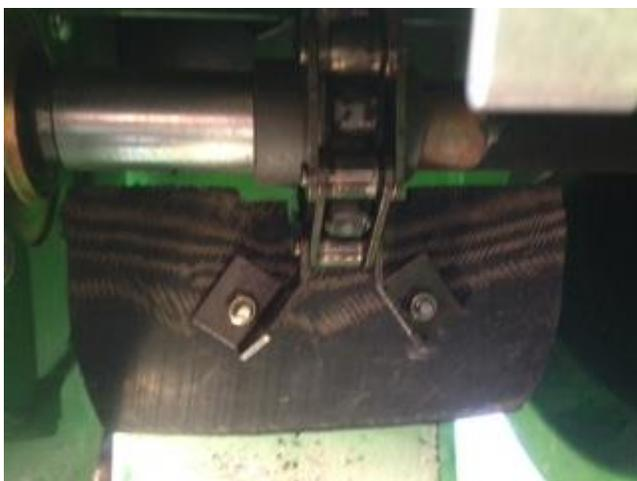
2. Aprire lo sportello di copertura a soffietto inferiore dell'elevatore granella pulita.
