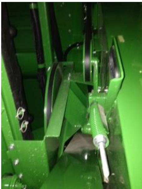
1. Allentare la puleggia di rinvio della cinghia di trasmissione dell'elevatore della granella pulita.
