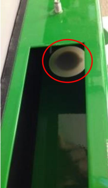
Il sensore di prossimità verifica che l'alloggiamento sia pieno di granella e l'aletta del sensore di umidità sia completamente coperta dalla granella. Quando l'interruttore è a contatto della granella si attiva il motorino della coclea. Ciò porta il motorino della coclea a spostare la granella attraverso il sensore di umidità, permettendo l'arrivo di nuova granella e controllando continuamente l'umidità.
